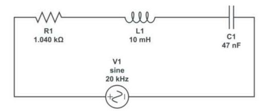
En alterna, además, tenemos lo que llamamos **impedancia**. Tiene parte real y parte imaginaria y sustituirá lo que en corriente continua era la resistencia en nuestras fórmulas. En las bobinas:
